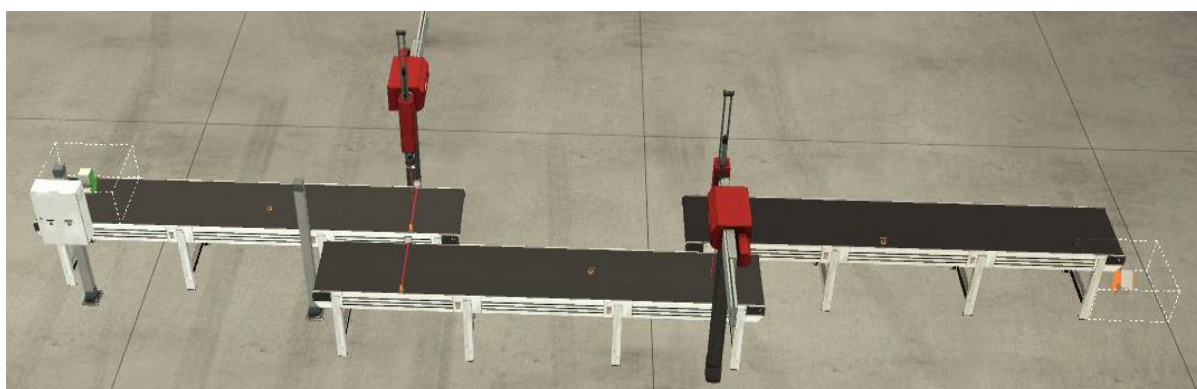
Рисунок 4.12 – Система управления из 3 конвейерных линии
